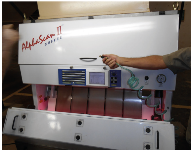
Figura 6. Higienização de selecionadora eletrônica com ar comprimido.
